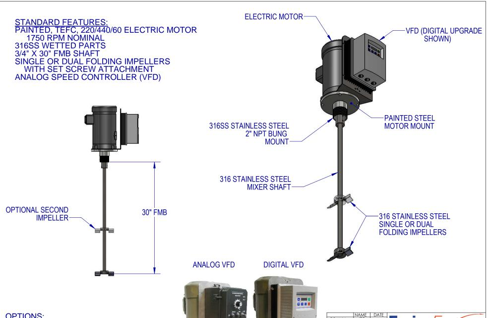
**OPTIONS:** 32 Ra FINISH ON ALL WETTED PARTS DIGITAL SPEED CONTROLLER (VFD)
